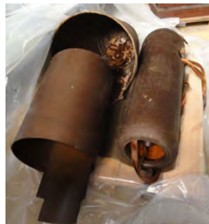
c.) Bei einer vor Ort durchgeführten Demontage der 400-kV- Durchführung eines 333MVA-/400kV- Trafopols wurde wegen thermischer Schädigung am Bolzen/Multikontakt der Ausleitungsbereich mit angehoben und beschädigt. Folgende Bilder: Der beschädigte Bereich wie nach Ausbau Aktivteil im Werk vorgefunden, sowie herunter gefallene Teile davon. Sein Originalzustand wird im Bild ganz rechts gezeigt.
