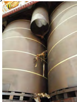
c.) Bei einer vor Ort durchgeführten Demontage der 400-kV- Durchführung eines 333MVA-/400kV- Trafopols wurde wegen thermischer Schädigung am Bolzen/Multikontakt der Ausleitungsbereich mit angehoben und beschädigt. Folgende Bilder: Der beschädigte Bereich wie nach Ausbau Aktivteil im Werk vorgefunden, sowie herunter gefallene Teile davon. Sein Originalzustand wird im Bild ganz rechts gezeigt.
