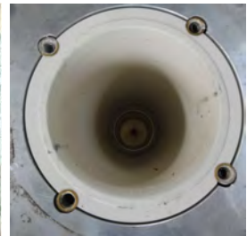
b.) 50MVA/110kV- Trafo. Teile einer völlig zerstörten 110kV-Pfisterer- Buchse liegen im Innern auf dem Ausleitungsbereich. Zum Vergleich: die unzerstörte Buchse einer anderen Phase.
